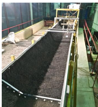
Рисунок 3. Экспериментальная установка с трапецидальным сечением лотка, покрытая исследуемым материалом
